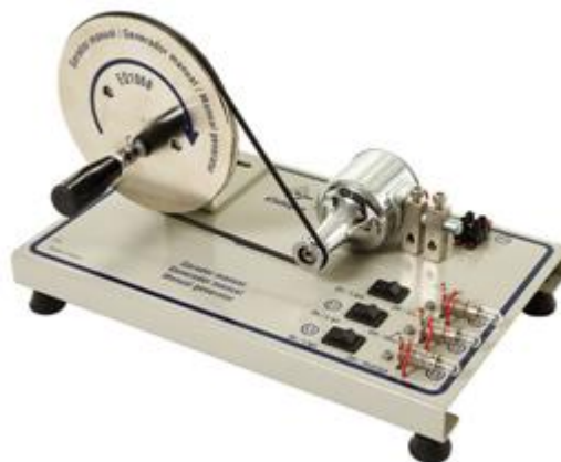
Figura 33 - Gerador Manual de Energia Elétrica
