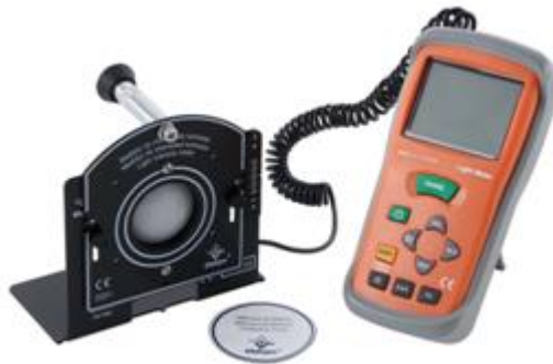
Figura 47 - Medidor de Intensidade Luminosa
