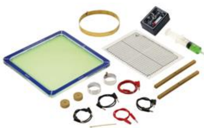
Figura 3.28 - Conjunto Superfícies Equipotenciais
